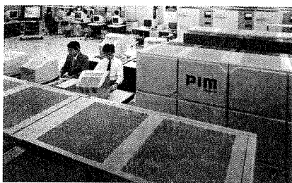
図7 ICOT マシンルームの並列推論マシン PIM 写真の手前に、PIMモデル-m (PIM/m)、右奥にPIMモデル-p (PIM/p)、さらに左の端末群の奥にPIMモデル-c (PIM/c) が見える
